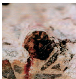
Powierzchnia stali bez warstwy ochronnej w teście zanurzeniowym.
