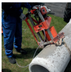
Prawidłowy montaż wiertnicy.
